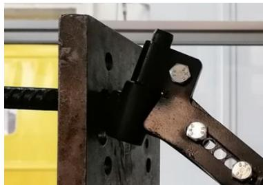
Le laboratoire a donc pris la décision de souder le gond sur toute sa longueur a l'équerre simulant la maçonnerie afin d'obtenir une rupture dans le système de déport de volet à rupture de pond thermique
