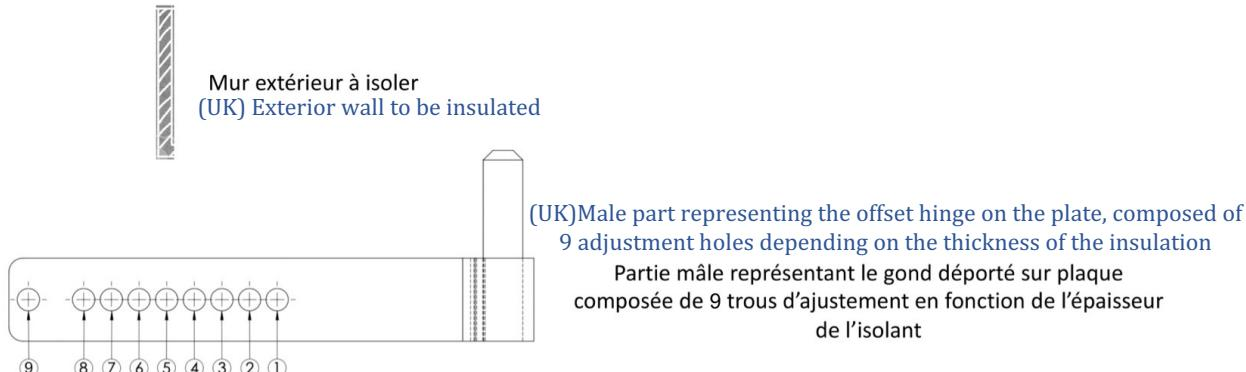
Les mesures ont été calculées sur la base d'un gond initial situé à une distance moyenne de 1cm du mur à isoler.
